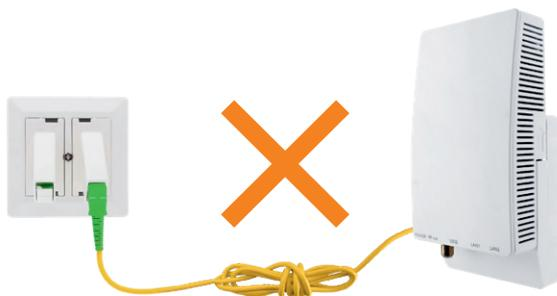
Unterschreiten des zulässigen Biegeradius des Patchkabel durch den Kunden führt zu **unnötigen Serviceanrufen und gebrochenen Glasfasern**.
