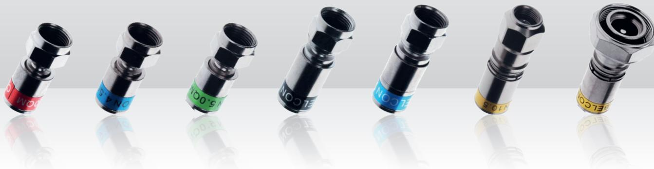
Universelle, wasserdichte Compressionsstecker mit NITIN-Beschichtung, Typauswahl erfolgt ausschließlich nach dem Außendurchmesser des Koaxialkabels, dadurch passgenau für eine Vielzahl von unterschiedlichen Kabeln. Sehr einfache Montage: Es werden nur der Kabelmantel und der Innenleiter (jeweils 6,5 mm) abisoliert und der Stecker direkt auf das Kabel gesteckt, das Geflecht muss nicht mehr zurückgeschlagen werden!
